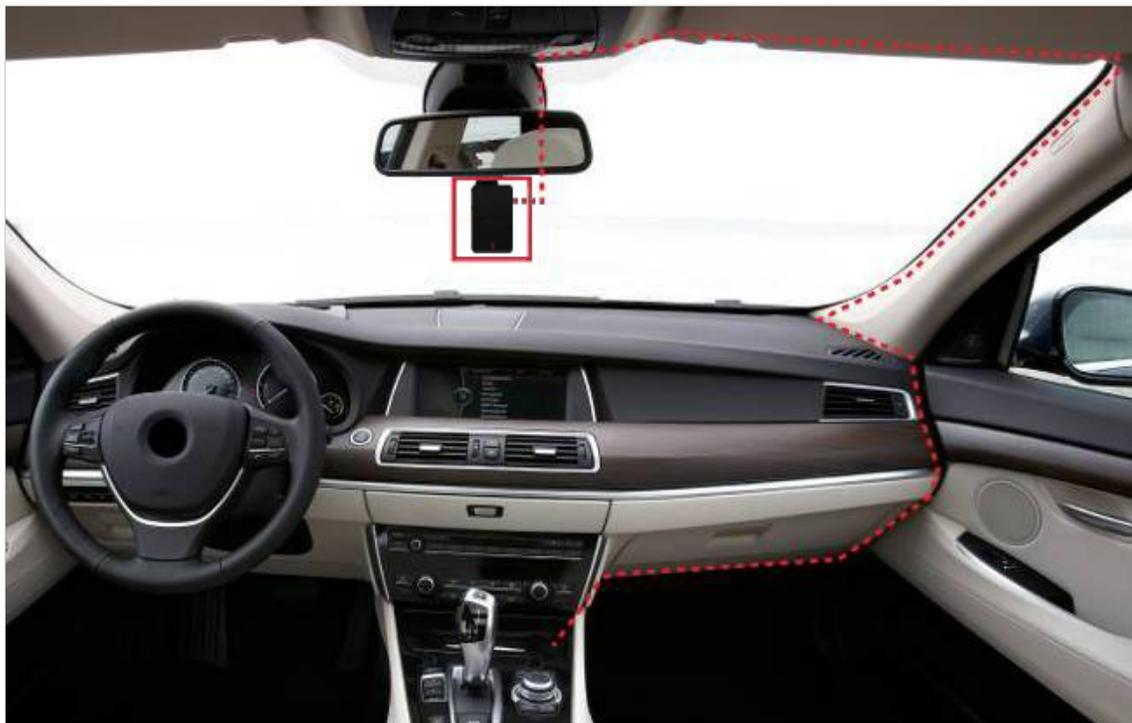
8. 車のエンジンをかけると、DriveProは自動的に起動して録画を開始します。DriveProアプリをダウンロードしたモバイル機器で映像を確認しながらDriveProの設置角度を調整します。
